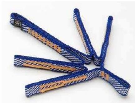
Pendant la chute, l'absorber se déchire ce qui entraîne une dissipation de l'énergie, mais une augmentation de la hauteur de chute.
